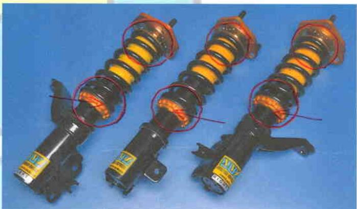
6) Nyní přejdeme k montáži podvozku na vozidlo. V případě typu tlumičů, kde je pružina mimo tlumič, pro základní nastavení výšky vozu namontujeme nejdříve pouze pružinu s redukcí a teprve po nastavení výšky vozu namontujeme na vůz i tlumič.
